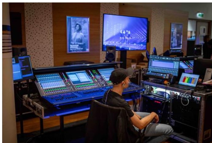
ESCではフェイルセーフな運用体制が重要な要素となった — 写真は2系統設置された独立型モニターコンソールのうちの1台
